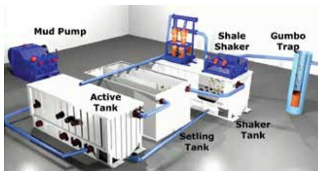
Design System Mud Tank pada RIG PDSI #38.2/D1000-E.
